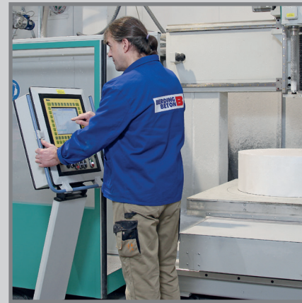
Afb. 1: De putonderbak optimal ® BASIC ® wordt exact op de computer gepland. Deze gegevens begeleiden de put gedurende het gehele productieproces.
