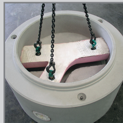
Afb.7: Tenslotte wordt de contramal van Styropor uit de verharde onderbak verwijderd.
