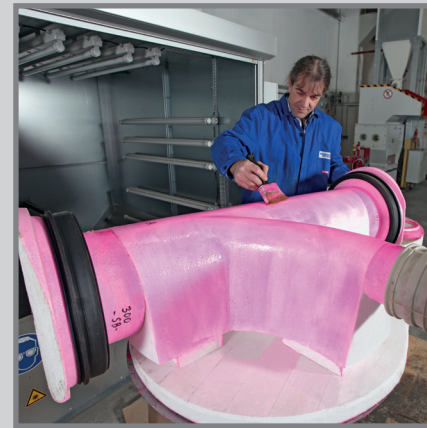
Afb. 3: Vervolgens wordt de contramal met de gewenste afdichtingen voorzien en met eco-bekistingsolie ingesmeerd.
