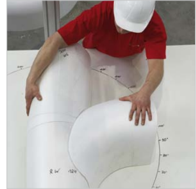
Afb. 3: De afzonderlijke aan- en afvoeren worden door middel van een hetelijmpistool samengelijmd tot een contramal.
