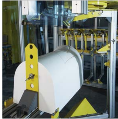
Afb. 2: Voor de bouw van een individuele mal is een speciale verwarmingsdraad-snijtechniek ontwikkeld.
