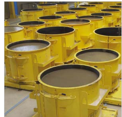
Afb.6: Na het vullen moeten de putten uitharden. Na 24 uur kan worden ontkist.
